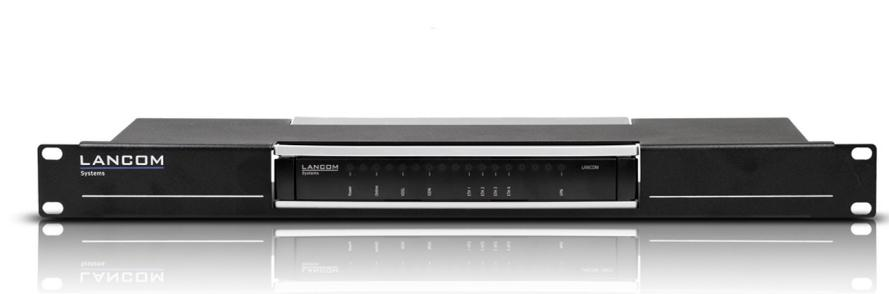
LANCOM Geräte im CPE-Gehäuse, wie beispielsweise Router oder Access Points, fügen sich nicht nur nahtlos in Ihre vorhandene Netzwerk-Infrastruktur ein, sondern lassen sich mit dem LANCOM Rack Mount professionell in einem 19"-Schrank montieren. In Ihrem Schrank wird dazu lediglich eine Höheneinheit benötigt, um das Gerät, Kabel und Netzteil sauber "verschwinden" zu lassen.
