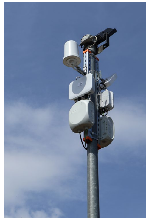
Bild-Quelle: M. Busch, Ausleuchtung Außengelände – Outdoor Access Point LANCOM OW-602 mit Outdoor-Rundstrahlantenne mit 360°-Abstrahlwinkel
