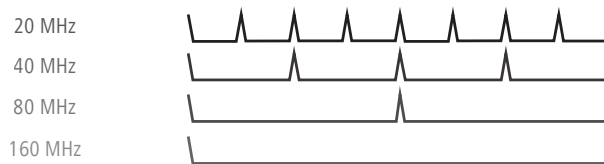
Abb. 1: Mögliche Kanalbandbreiten bei Wi-Fi 6
