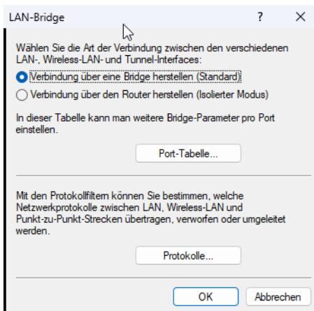
5. Öffnen Sie die **Port-Tabelle**. Um die Daten vom Mobilfunkmodem an einen Ethernet-Port weiterzugeben, müssen das WWAN-Interface und ein entsprechendes LAN-Interface in eine gemeinsame Bridge-Gruppe konfiguriert werden. In diesem Beispiel werden LAN-2 und WWAN in die Bridge-Gruppe BRG-2 konfiguriert. Verwenden Sie ggf. eine andere Bridge-Gruppe, falls BRG-2 schon für WLAN oder andere Funktionen verwendet wird.
