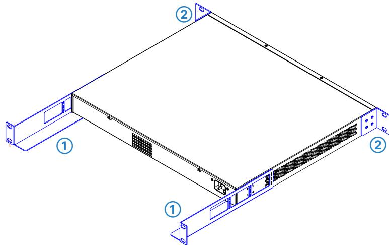
Beginnen Sie mit der Montage der beiden hinteren Auflageschienen **①**, indem Sie diese durch die Langlöcher mit jeweils 2 der 8 beiliegenden Rackbefestigungs-Schrauben von hinten im Rack befestigen.
