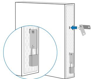
Sichern Sie abschließend das LANCOM Lock mit dem beiliegenden Vorhängeschloss.
