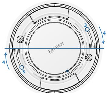
Die Schrauben **C** sind nun in Ihrer Endposition **(5)** verriegelt, und der Access Point ist damit auf der Montageplatte fixiert.
