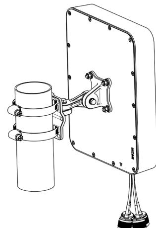
Dann verbinden Sie den Mastflansch handfest mit dem an der Antenne montierten Verbindungsarm (**B**) mittels einer beiliegenden Schraube (**D**), einer Unterlegscheibe (**F**), einem Federring (**E**) und einer Mutter (**G**).
