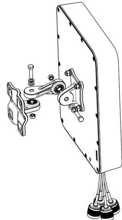
Achten Sie darauf, dass sich der Federring (**E**) direkt unter dem Schraubenkopf befindet und dass die Kabel der Antenne nach unten zeigen.
