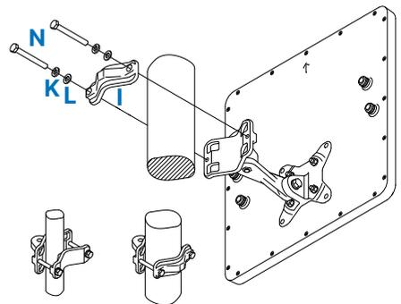
Dann verbinden Sie den Mastflansch (C) handfest mit dem bereits an der Antenne montierten Verbindungsarm (B) mittels einer beiliegenden Schraube (J), einem Federring (K), einer Unterlegscheibe (L) und einer Mutter (M).
