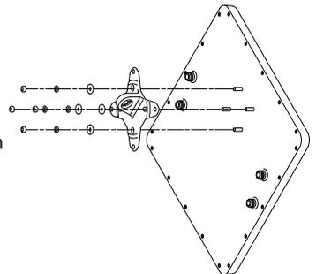
Befestigen Sie dann den Verbindungsarm (B) mithilfe einer Schraube (J), eines Federrings (K), einer Unterlegscheibe (L) und einer Mutter (M) handfest am Anschlussflansch (A). Achten Sie darauf, dass sich der Federring (L) direkt unter dem Schraubenkopf befindet.
