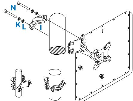
Bei Mastdurchmessern über 62,5 mm benötigen Sie passende Bandschellen (H) (nicht im Lieferumfang enthalten) und führen diese, wie in der Übersicht gezeigt, durch den Mastflansch und um den Mast herum und ziehen diese fest, nachdem Sie den Mastflansch ausgerichtet haben.
