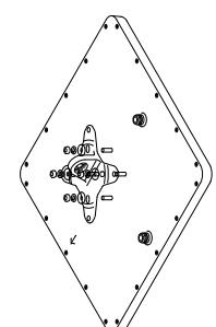
Befestigen Sie dann den Verbindungsarm (B) mithilfe einer Schraube (J), eines Federrings (K), einer Unterlegscheibe (L) und einer Mutter (M) handfest am Anschlussflansch (A). Achten Sie darauf, dass sich der Federring (L) direkt unter dem Schraubenkopf befindet.
