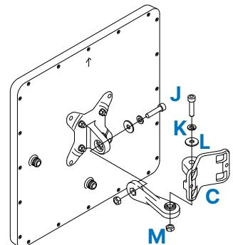
Achten Sie darauf, dass sich der Federring (K) direkt unter dem Schraubenkopf befindet und dass der Pfeil auf der Rückseite des Antennengehäuses nach oben zeigt.
