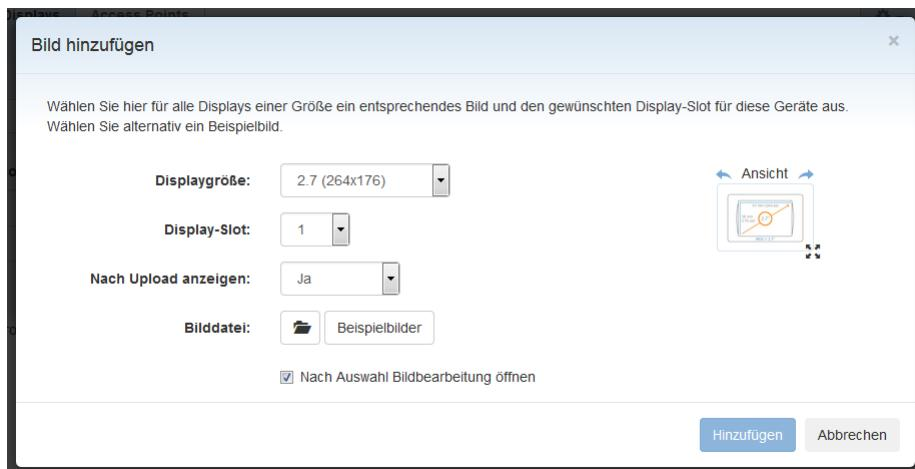
Die Display-Größe wird automatisch erkannt. Über "Bilddatei (PNG, BMP)" können Sie das gewünschte Bild auswählen. LANCOM Wireless ePaper Displays unterstützen monochrome Bitmaps im BMP- oder PNG-Format. Die Auflösung der Bilder muss der des Displays entsprechen. Die Anzeige des Bildes erfolgt innerhalb eines Zeitraums von ca. 10 Sekunden.
