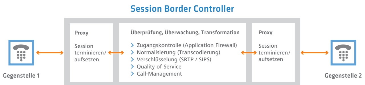
Abb. 1: Funktionsweise eines Session Border Controllers
