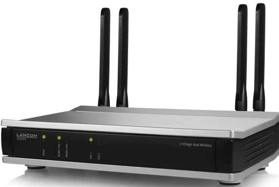
Der LANCOM L-322agn dual Wireless ist ein leistungsstarker 11n-WLAN Business Access Point. Er bedient parallel 11n-Clients im 2,4 GHz- und 5 GHz-Frequenzband mit professionellem und zuverlässigem WLAN bei optimaler Lastverteilung. Eine ideale Kombination für professionelles 300 MBit/s-WLAN im Business-Bereich.
